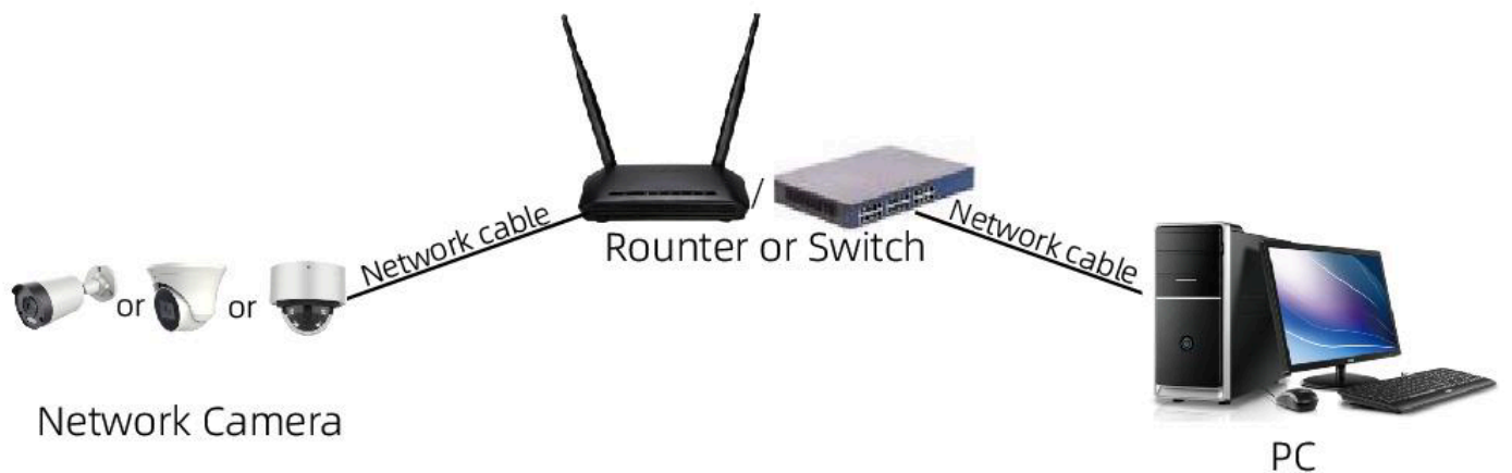
Figure 1-2 Connexion via un commutateur ou un routeur
